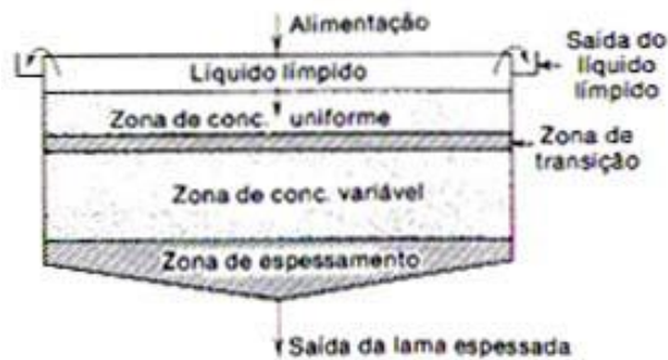
Figura 9. Disposição das zonas em um decantador
